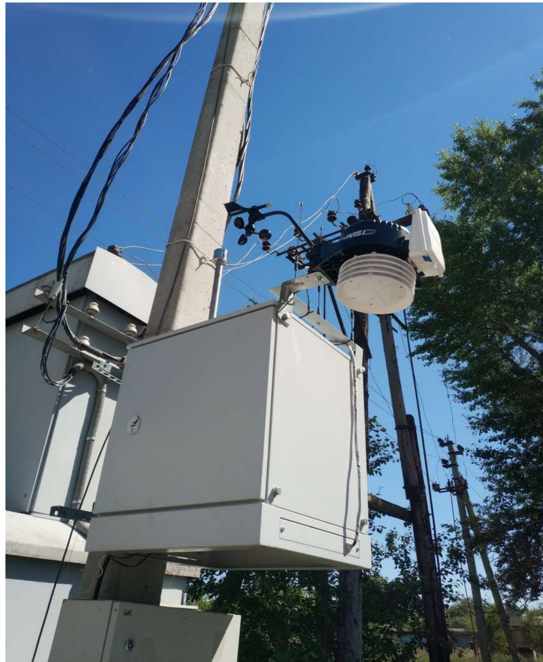
Пост мониторинга с пылемером AIR XD Trolex в термошкафу и метеостанцией Davis
